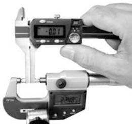
3. Chiudere il calibro e misurare con un altro strumento centesimale l'ingombro becchi + puntalini
