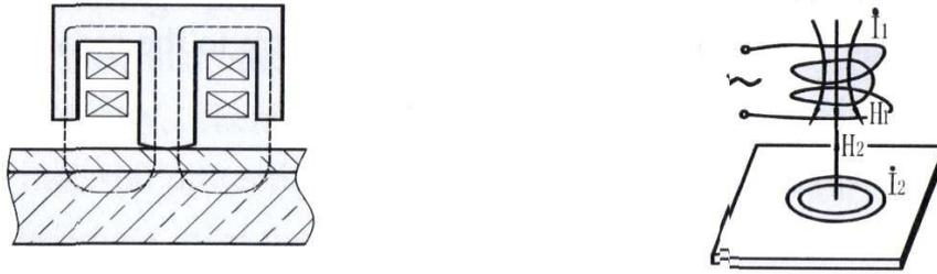
Figura 1. A sinistra: metodo magnetico. A destra: metodo elettromagnetico
