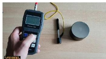
6. Una volta ultimato la correzione del valore di durezza e portato questo allo stesso valore del provino, la calibrazione è ultimata e procedere alla registrazione premendo invio
