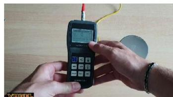
4. Una volta ultimate le 5 misurazioni, il durometro effettua in automatico la media delle 5 suddette prove.
